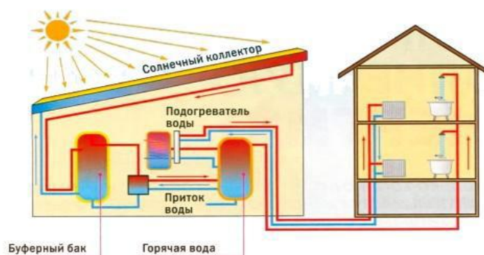
Рисунок 2. Использование солнечных коллекторов для обогрева зданий
