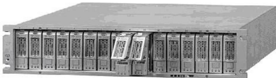
Сурет 3 - Бастапқы деңгейдегі мәліметтерді сақтаудың қарапайым жүйесі (SunStorageTek 6140)
