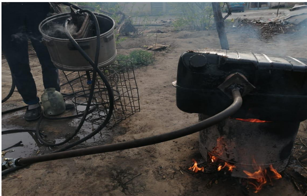
15-сурет – Пластик қалдықтан екінші реттік өнім алу процесі
