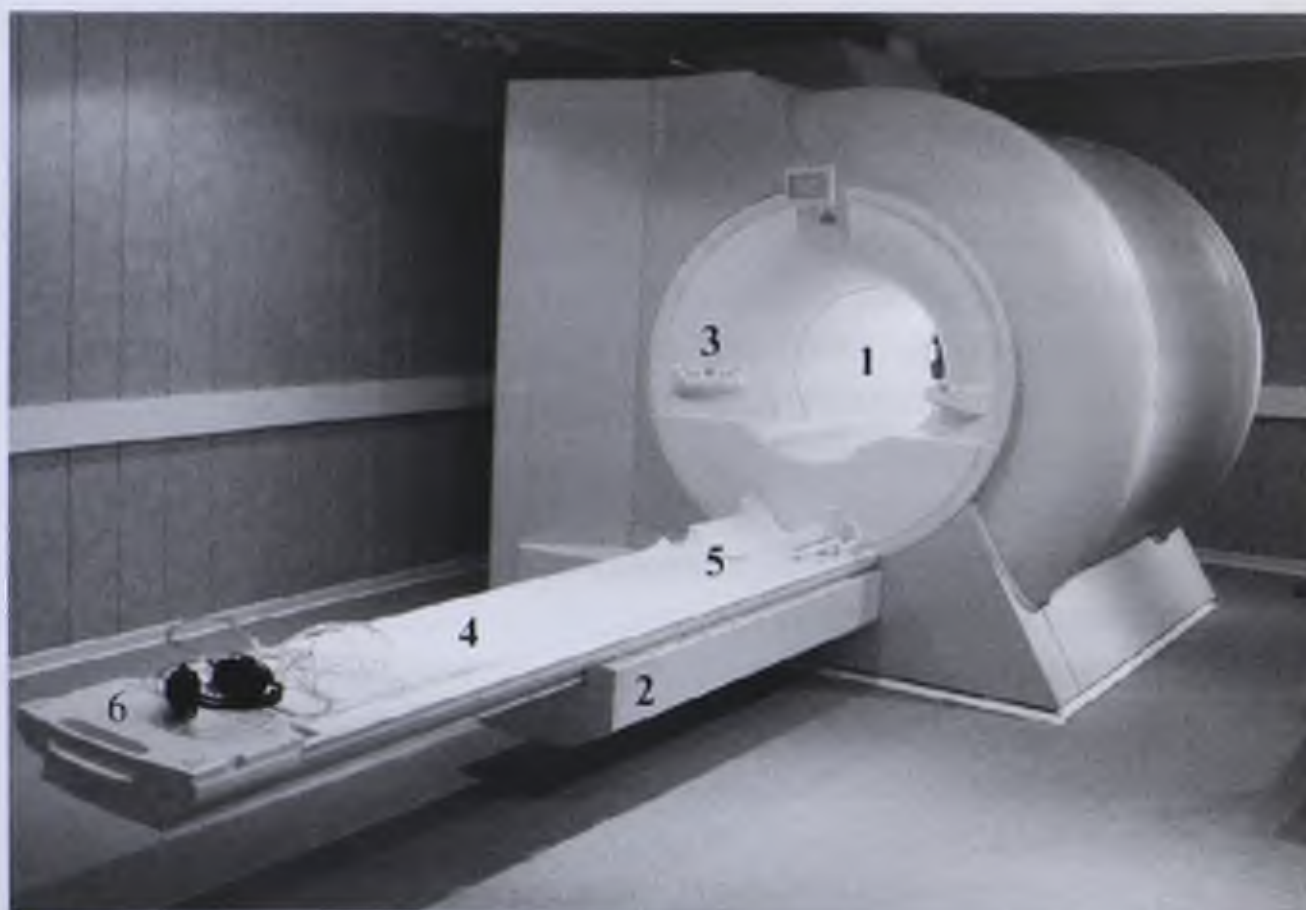
Рис. 5.3. Внешний вид высокопольного магнитно-резонансного томографа: 1 — тоннель магнита; 2 — стол пациента, который перемещается в тоннель (центр) магнита; 3 — пульт управления столом, с системой центровки и позиционирования области исследования; 4 — встроенные в стол радиочастотные катушки для исследования позвоночника; 5 — основные радиочастотные катушки для исследования головного мозга; 6 — наушники для связи с пациентом
